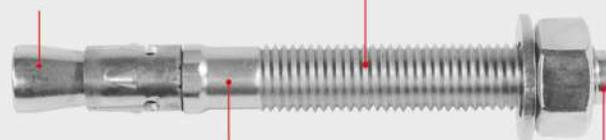
**El collar distintivo** asegura que el casquillo se mantenga en su posición en caso de encontrarse con armaduras y perforaciones defectuosas durante la introducción del anclaje. Además es indicativo de su conformación en frío, lo que le confiere una gran ductibilidad.
